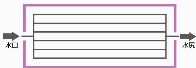
【図2】溝切りの施工例
