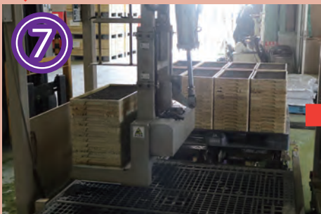
⑦ 出来上がった苗箱は、15枚ずつ自動でパレットに積み込まれます。
