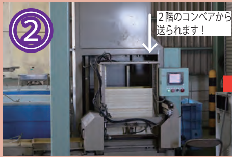
② エレベーターで階下の全自動播種機に送られます。
