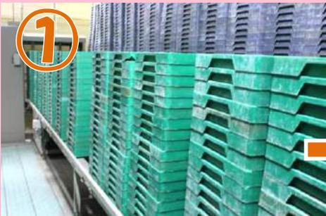
① 2階のコンベアに20枚ずつ重ねて並び、エレベーターへ流していきます。
